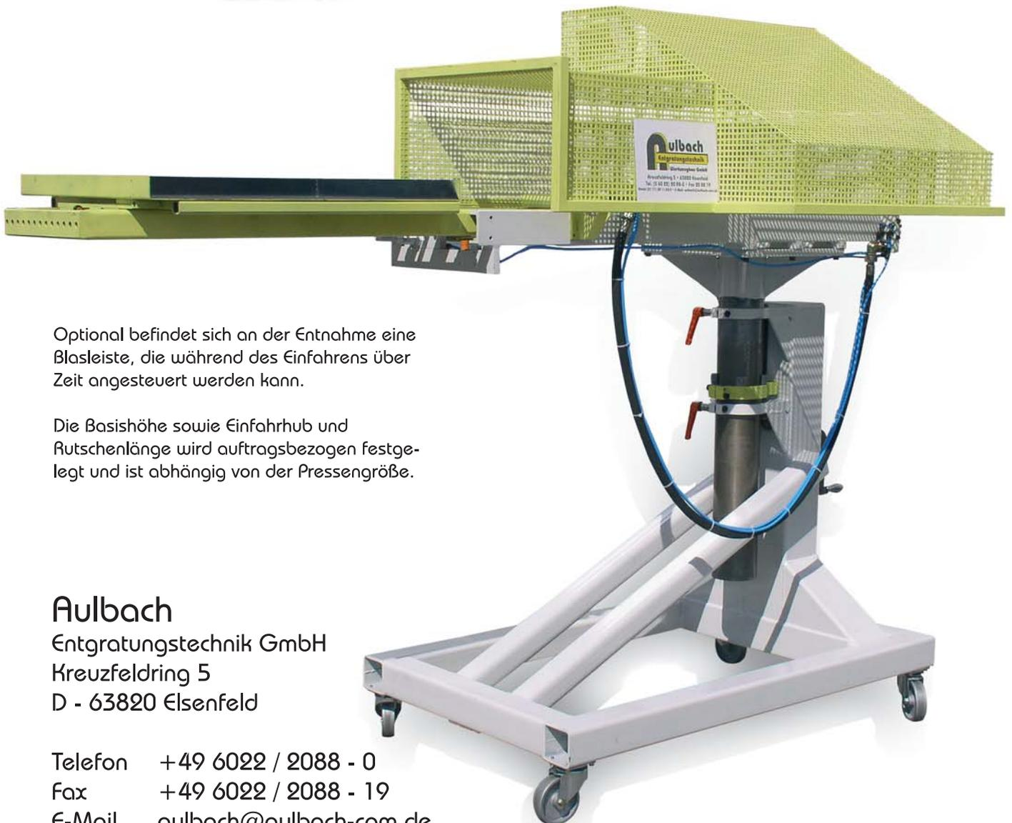
Optional befindet sich an der Entnahme eine Blasleiste, die während des Einfahrens über Zeit angesteuert werden kann.
