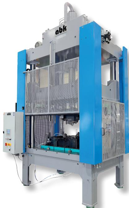
Bild 4: Die Entgratpresse muss entsprechend ausgelegt sein. Einbauhöhe, Niederhalter, Anzahl der Seitenschieber, Größe, Durchbrüche, all das muss mit dem Werkzeug korrespondieren (Werkbilder: Aulbach GmbH, Eisenfeld)
